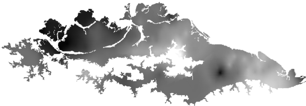
Figura 16 - superfícies de profundidade do Disco de Secchi obtida com o interpolador krigeagem ordinária – fevereiro.
