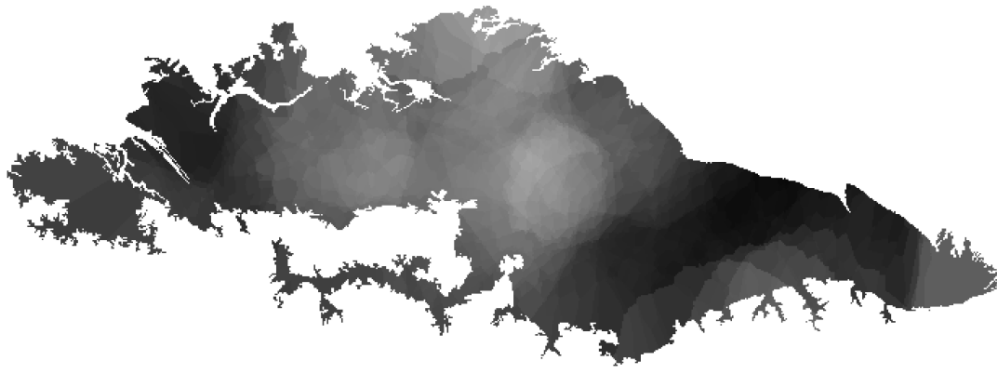
Figura 7 - superfícies de profundidade do Disco de Secchi obtida com o interpolador média simples - setembro.
