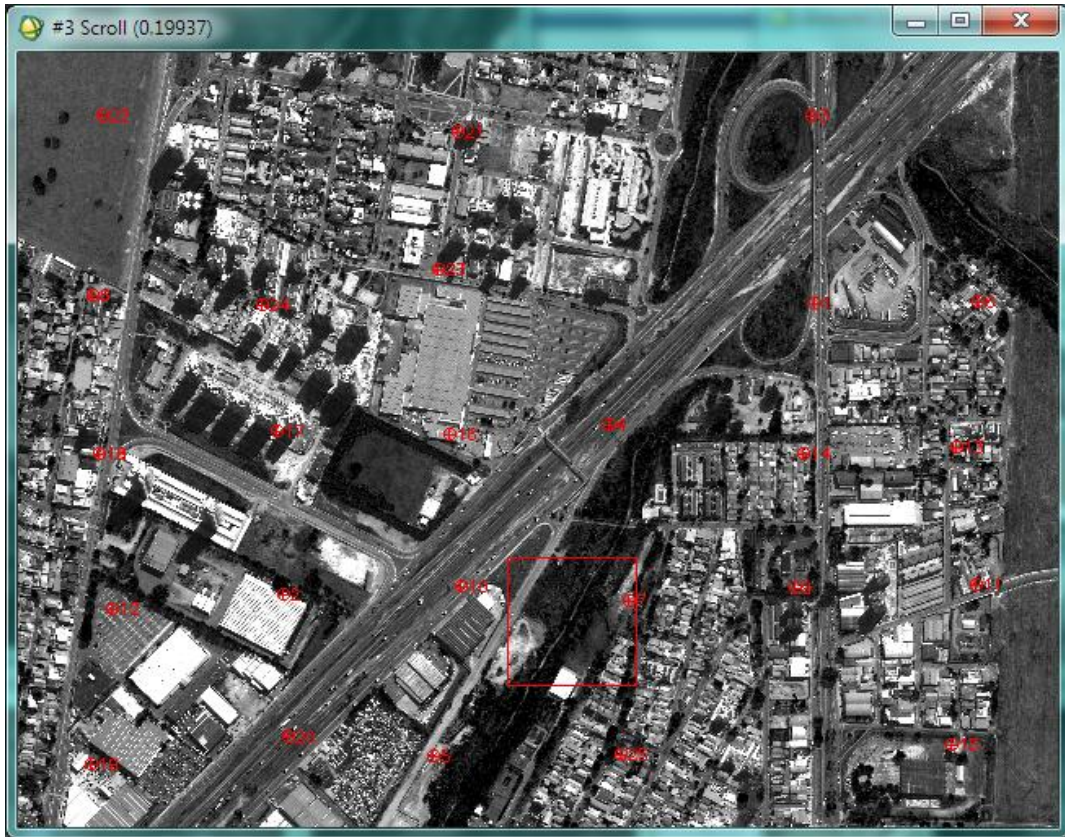
Figura 3. Aquisição automática de pontos de controle do Recorte no ENVI.
