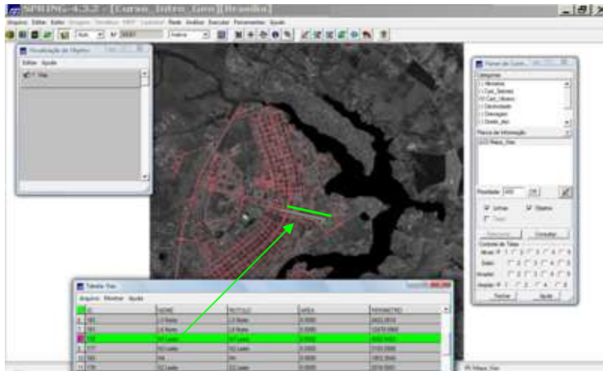
Figura 14 - Seleção (em verde) de objetos vias através da tabela de atributos. A cada via se relaciona uma série de atributos (“características”) tais como: Nome, Rótulo, Área, Perímetro, Pistas, Velocidade Média.
