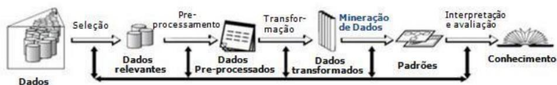
Figura 3.2. Etapas da descoberta de conhecimento em banco de dados. A mineração de dados corresponde a uma das etapas do processo da transformação de dados em conhecimento.
