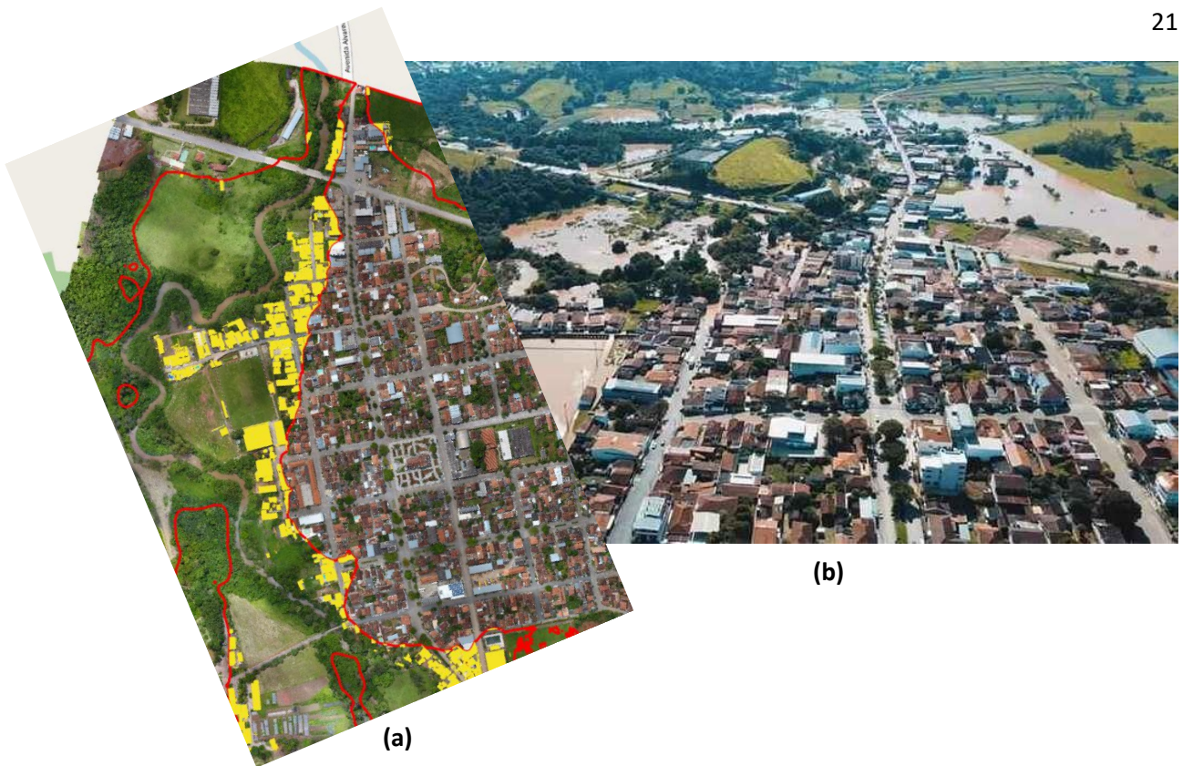
FIGURA 4.10. Em (a) a simulação gerada a partir do modelo desenvolvida neste trabalho e em (b), imagem real de uma inundação ocorrida em fevereiro de 2022
