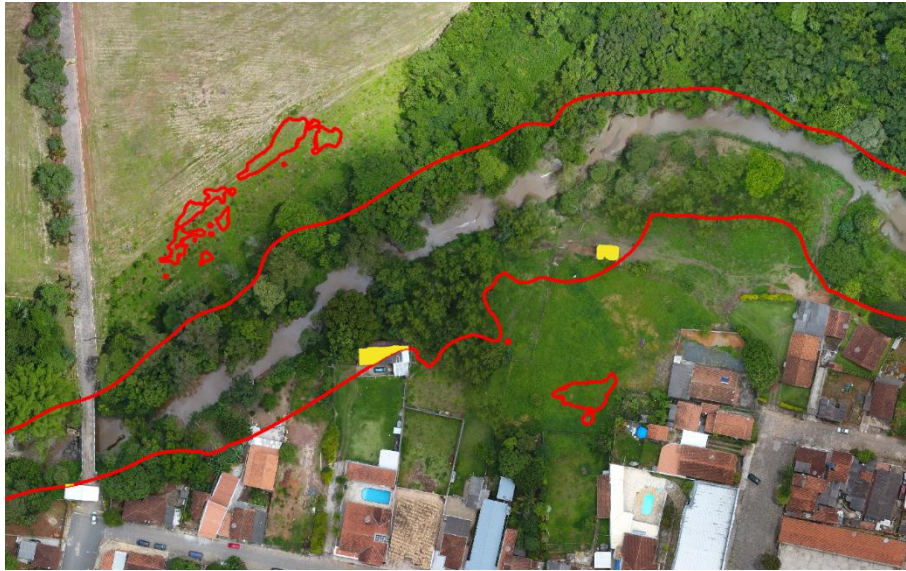
FIGURA 4.4.1 Construções atingidas na simulação do aumento do nível do rio subindo 4 metros.
