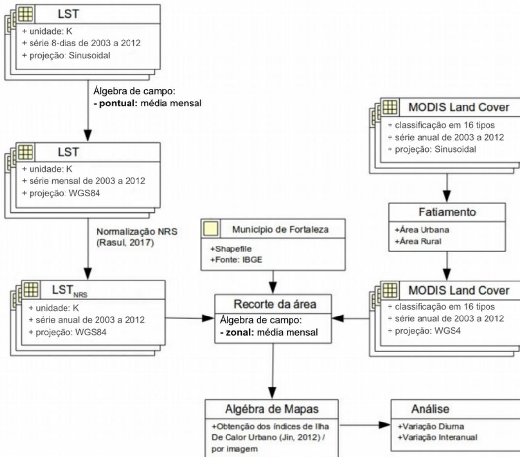
Fig. 2. Diagrama OMT-G com a metodologia sintetizada de geoprocessamento
